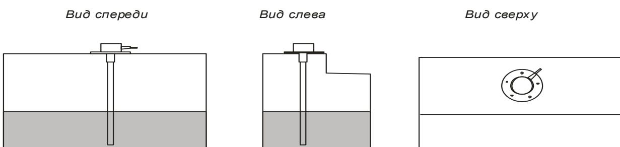
3) Присоединительные размеры датчика позволяют устанавливать его в штатные места вместо существующих «поплавковых» датчиков с сохранением функций указателя и лампочки аварийного остатка топлива. Такая установка годится для автомобилей, эксплуатирующихся на шоссе в равнинной местности.
