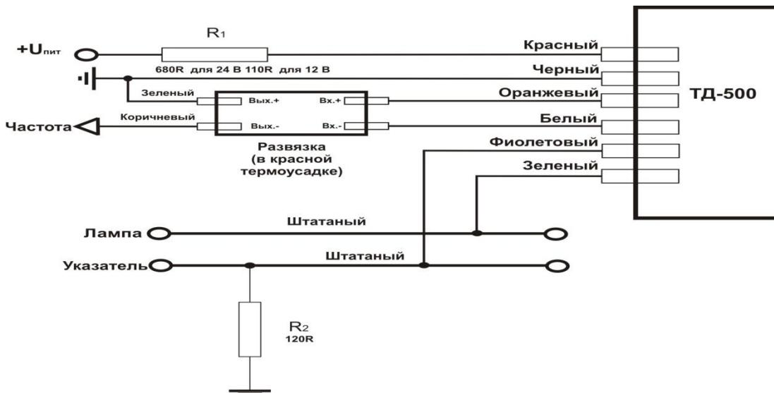
Рис. 14 Схема включения в частотном режиме с замыканием на массу.
