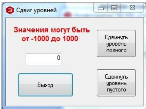
При настройке датчика есть возможность сдвинуть ранее установленные пустой и полны уровни. Данная процедура полезна при отсутствии или затрудненном доступе к ранее установленному датчику. Для сдвига задайте в соответствующем окне число, на которое нужно сместить установленный уровень и нажмите кнопку Сдвиг.
